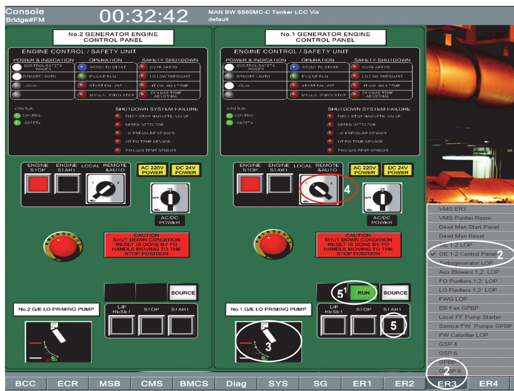
Рис. 3. Панель тренажера, иллюстрирующая подготовку и ввод в эксплуатацию системы смазки дизель-генераторов
